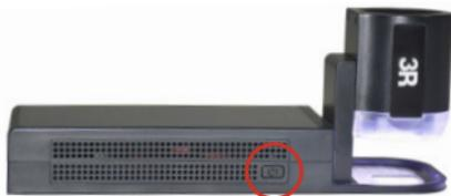
Halten Sie die Einschalttaste für 2 Sek. gedrückt, um das Mikroskop einzuschalten. Die Anyty App sollte sich automatisch öffnen. Falls nicht, wählen Sie sie im App Menü aus (Seite 3). Um das Mikroskop in den Ruhezustand zu versetzen, drücken Sie einmal kurz auf die Einschalttaste. Drücken Sie erneut, um den Standby Modus zu beenden.
