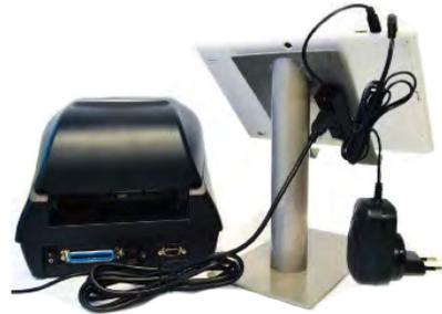
Verbinden Sie den Drucker und das Tablet mit dem USB-Kabel. Anschließend verbinden Sie die Geräte mit den jeweils passenden Stromkabeln. Der Dekoband Drucker und das Tablet sind nun bereit, um in Betrieb genommen zu werden.
