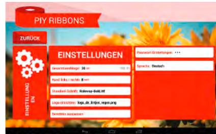
Unter dem Punkt „Einstellungen“ können Sie die Bandlänge einstellen, die bedruckt werden kann. Außerdem können Sie den Abstand des Druckes zum Rand bestimmen sowie ein Logo, welches zusätzlich mit auf das Band gedruckt werden kann. Wie Sie ein Logo auf das Tablet übertragen können, erfahren Sie in dem beiliegenden Handbuch.
