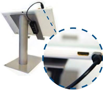
Befestigen Sie den USB-Hub mit dem doppelseitigen Klebeband am Standfuß. Sie können auch das Tablet mit Klebeband befestigen. Verbinden Sie nun den USB-Hub mit dem Tablet, indem Sie das Kabel in den Micro-USB Port einstecken.
