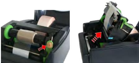
Fädeln Sie nun das Dekoband ein. Drücken und halten Sie den kleinen schwarzen Knopf auf den grünen Führungsschienen, um diese zu öffnen und zu schließen. Fixieren Sie das Dekoband mit den Schienen. Achten Sie dabei darauf, dass das Band nicht von den Schienen eingeklemmt wird.
