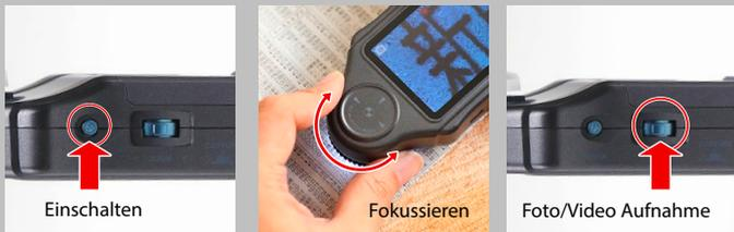
Keine Zeit mehr verlieren mit komplizierten Einstellungen. Einfach einschalten und anwenden. Mit nur einem Tastendruck können Sie Bilder aufnehmen/speichern und durch das leichte Drehen des Einstellrads die richtige Vergrößerung auswählen. Kein Aufladen mehr notwendig, einfach Batterien einlegen und sofort starten.
